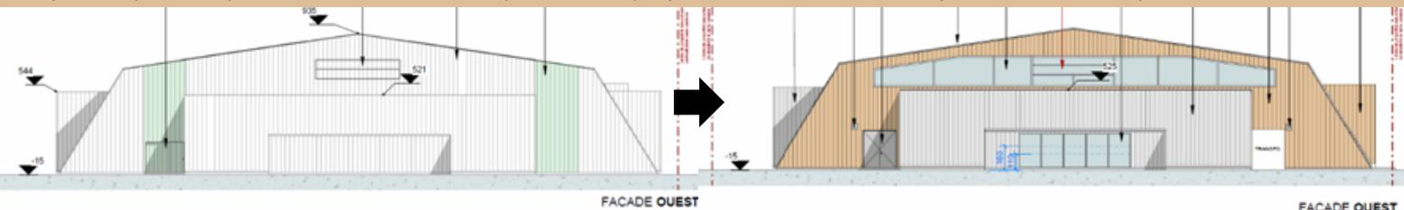
La partie aménagement de la salle multi-activités va d'abord consister à l'isoler phoniquement par la création d'une cloison de séparation entre les 2 courts allant jusqu'à la toiture. Le sol sera recouvert d'une surface dite « multi-usages » et des panneaux d'amélioration acoustique seront installés en parois et au plafond. Pour compléter, des baies vitrées seront rajoutées du côté du parc. L'îlot central ne sera pas modifié, et les rangements en cages métalliques n'ont pas été retenus.
